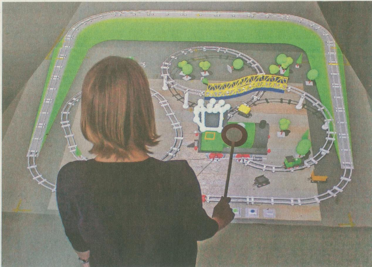
Eine Kamera an der Decke erfasst die Bewegungen der Kelle und überträgt sie auf die virtuellen Loks und Wagen, die sich über die auf den Boden projizierte Gleisanlage bewegen.
